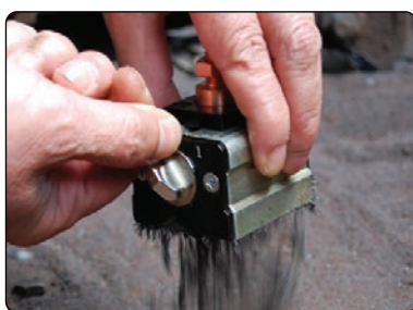
A PowerBase™ földelő mágnes kikapcsolása után lehullanak a fémszennyeződések.
